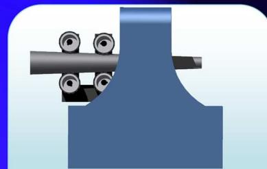
AVANZAMENTO AUTOCENTRANTE PER TUBI CONICI
